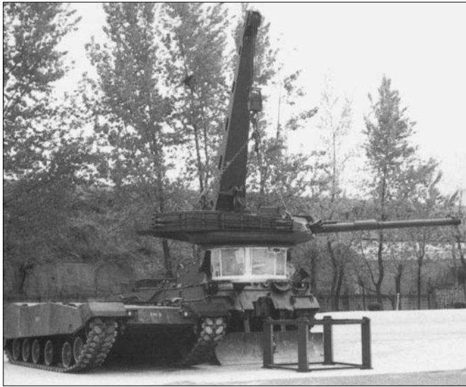
Южнокорейская БРЭМ К1 имеет то же специальное оборудование, что и германская БРЭМ «Буффел»
