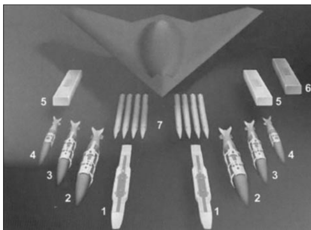
В ходе НИОКР изучаются различные варианты полезной нагрузки боевых БЛА: 1 – две УАБ SDBR (Small Diameter Bomb Rack); 2 – две УАБ JDAM калибра 2 000 фунтов; 3 – две УАБ JDAM калибра 1 000 фунтов; 4 – две УАБ JDAM калибра 500 фунтов; 5 – два топливных бака; 6 – два специальных контейнера с оборудованием согласно полетному заданию, 7 – восемь УАБ SDB (Small Diameter Bomb)
