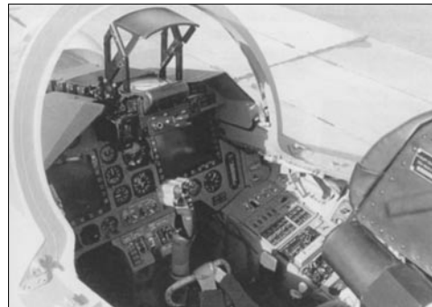
Приборная доска передней кабины тактического истребителя J-13
