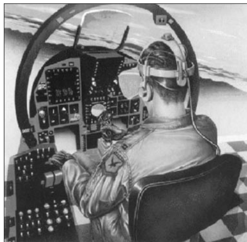
Эскизный проект тренажера, предназначенного для поддержания уровня натренированности оператора боевого БЛА
